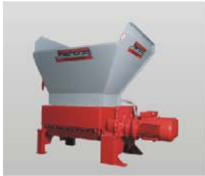
Série RMZ 500 - RMZ 1000 S, broyeur à quatre axes, idéal pour le broyage de longs morceaux
